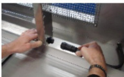
Anslutning av UV-ramen sker med en speciell kontakt
